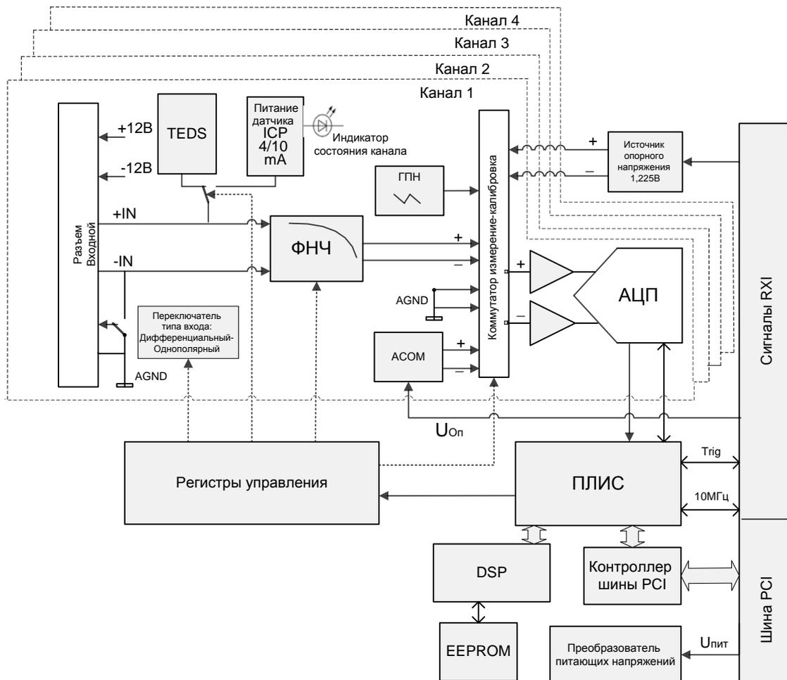
Рис. 3. Функциональная схема модуля MR202
