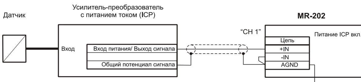
**Рисунок 15-Схема подключения внешнего усилителя преобразователя с питанием током ICP к входу модуля MR-202**
