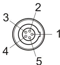
**Рисунок 2-Расположение контактов входного разъема (LEMO EGG 1B 305)**
