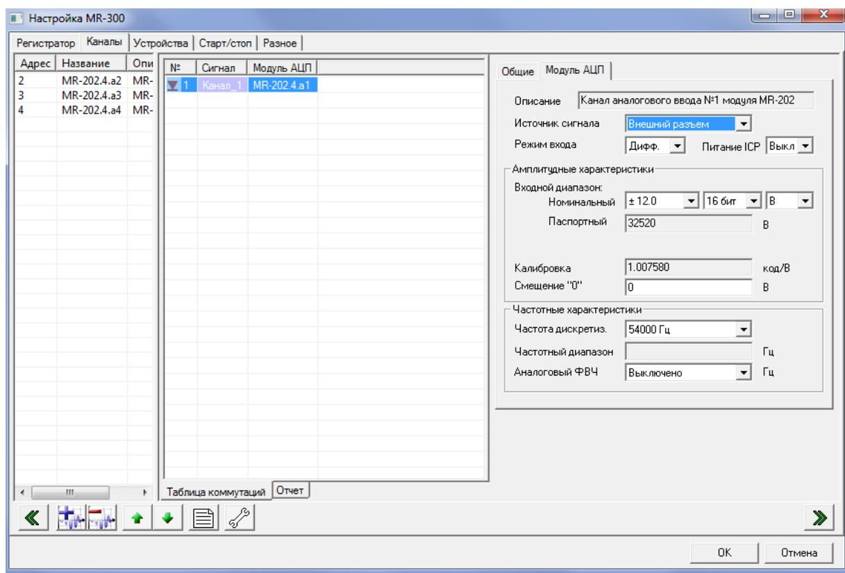
**Рис. 10. Настройка АЦП каналов модуля**
