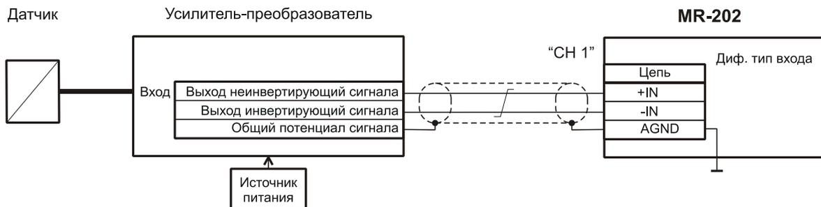
**Рисунок 13-Схема подключения внешнего усилителя-преобразователя с дифференциальным выходом к дифференциальному входу модуля MR-202**
