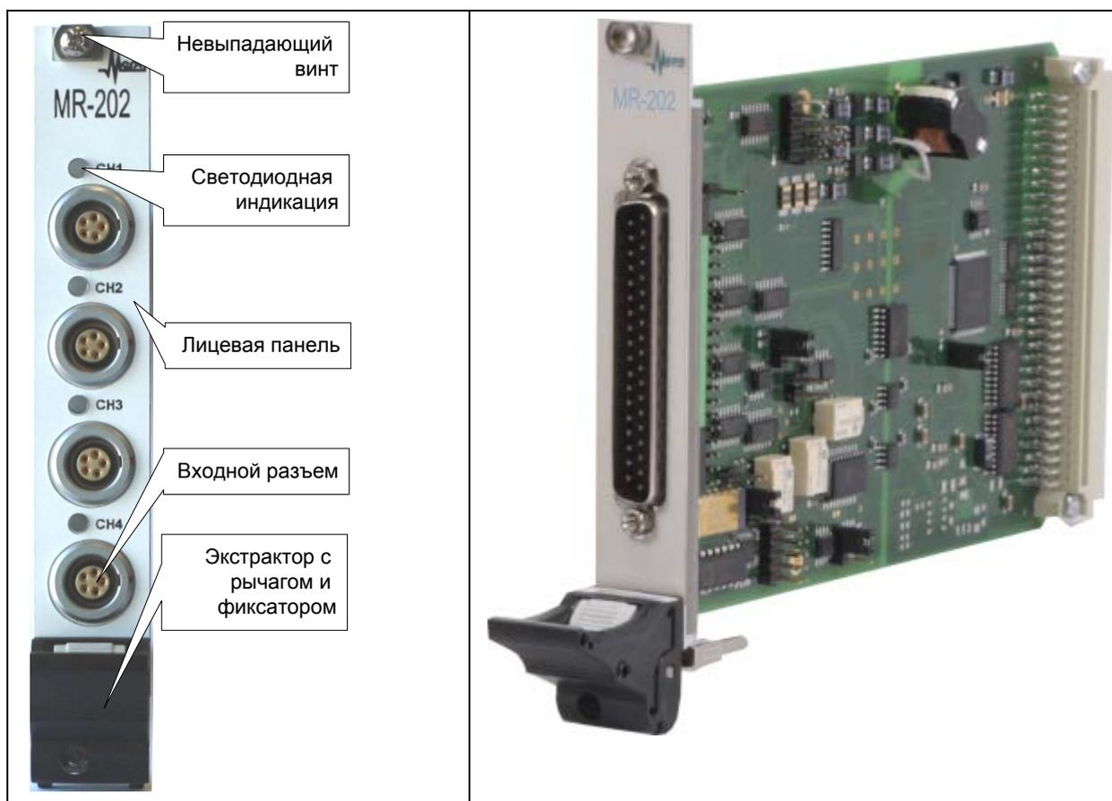
Рис. 1. Вид на переднюю панель и входной разъем модуля MR-202:
